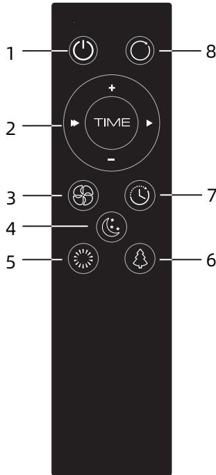
1- 开关键：按下开关键，机器启动；再按下此键，机器停止运行。
